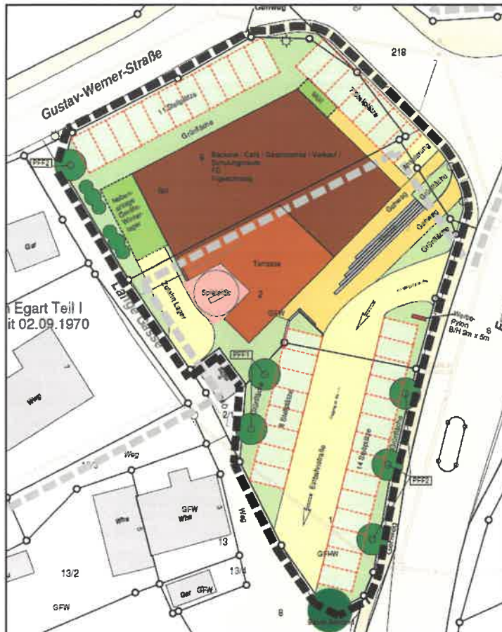
Abb: Darstellung Schleppkurven Verkehrssituation Plangebiet.
